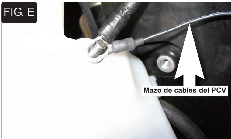
6. Unir el cable de masa del PCV al motor utilizando el tornillo inferior que sujeta el depósito del líquido refrigerante al motor (Fig. E). Comprobar que el cable de masa del PCV queda entre el depósito del líquido refrigerante y el motor.
