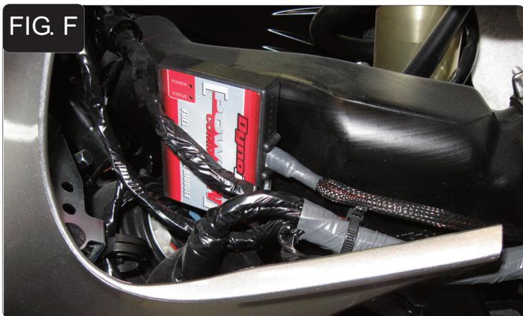
8. Colocar el PCV pegado al tubo de admisión de aire lateral izquierdo. Utilizar la cinta de velcro que se incluye para sujetar la unidad en su posición.
