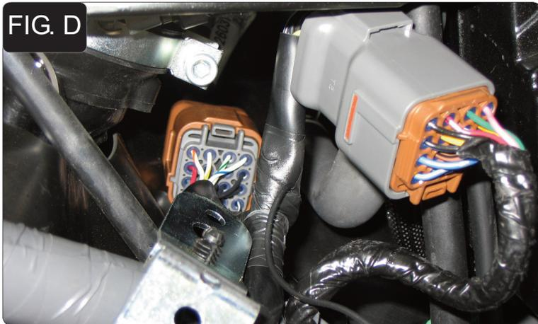
5. Conectar el PCV en línea con los mazos de cables principal y del cuerpo del acelerador (Fig. D).
