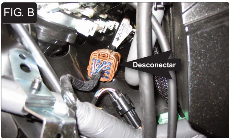
3. Desconectar el mazo de cables de serie del mazo de cables del cuerpo del acelerador (Fig. B). Estos conectores son de color MARRÓN y están debajo de los cuerpos del acelerador.
