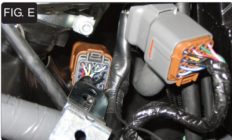
6. Conectar el PCV en línea con el mazo de cables de serie y el mazo de cables del cuerpo del acelerador (Fig. E).
