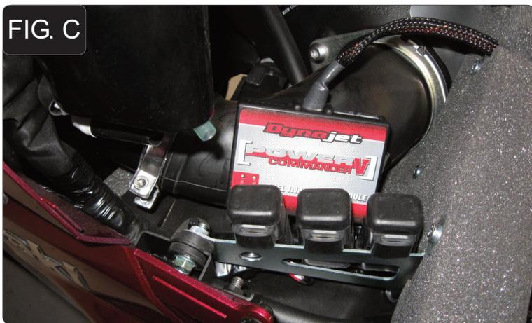
4. Colocar el PCV contra el tubo de admisión de aire lateral izquierdo. Utilizar la cinta de velcro que se suministra para sujetar la unidad en su posición.
