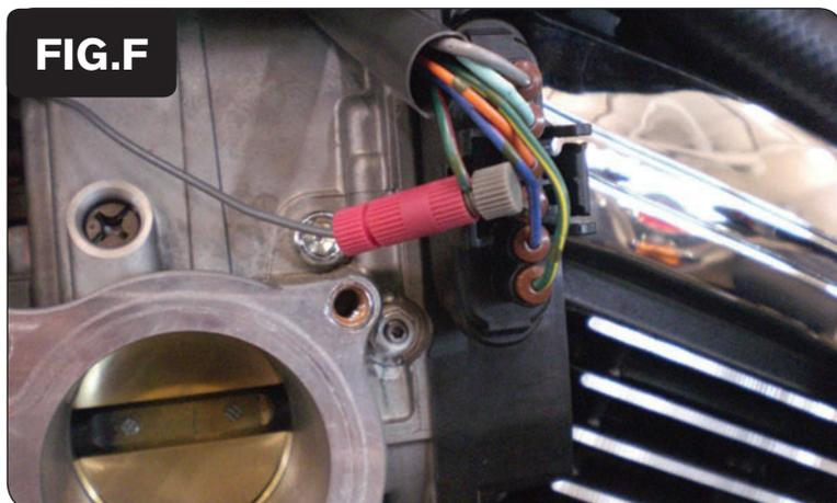
10. Unir el cable GRIS del PCV al cable VERDE/ROJO del servomotor del TPS (Fig. F).
