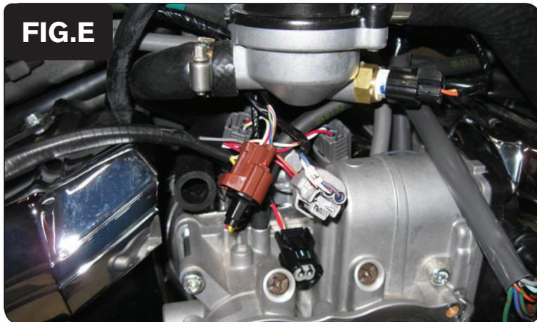
9. Conectar el mazo de cables del PCV en línea con el mazo de cables de serie y los inyectores (Fig. E).
