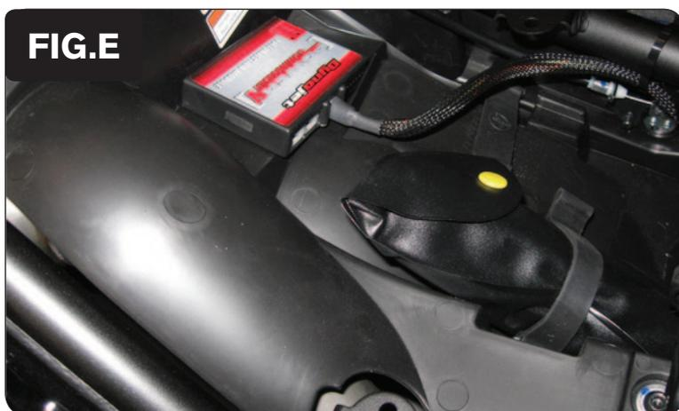
8. Sujetar el PCV en la sección de cola con la cinta de velcro que se suministra (Fig. E).
