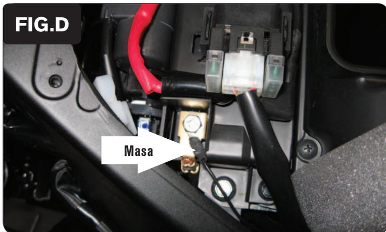
7. Unir el cable de masa del PCV al borne negativo de la batería (Fig. D).
