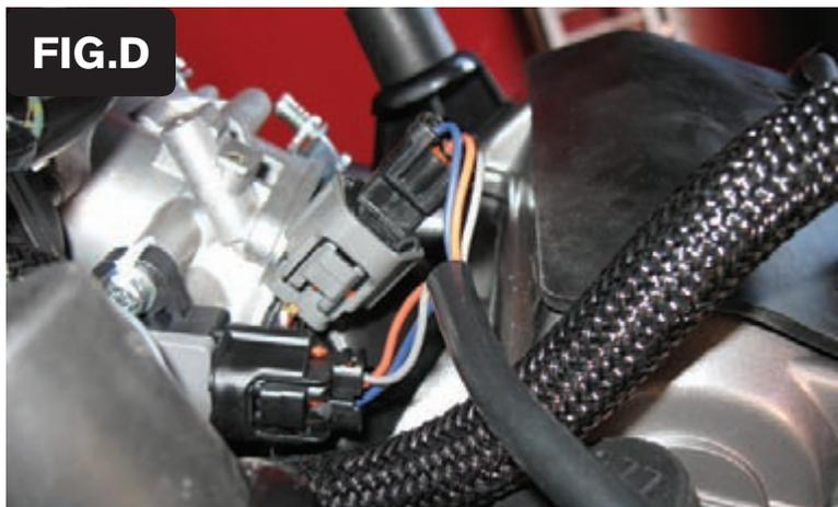
9. Collegare il connettore 3 pin del PCV in linea con il sensore TPS ed il connettore (Fig. D).
