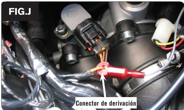
12. Localizar el mazo de cables del Sensor de Posición del Acelerador, a la izquierda de los cuerpos del acelerador.
