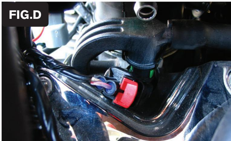
6. Localizar el mazo de cables de serie en el inyector trasero (Fig. D). Soltar el clip ROJO y desconectar el conector del inyector.
