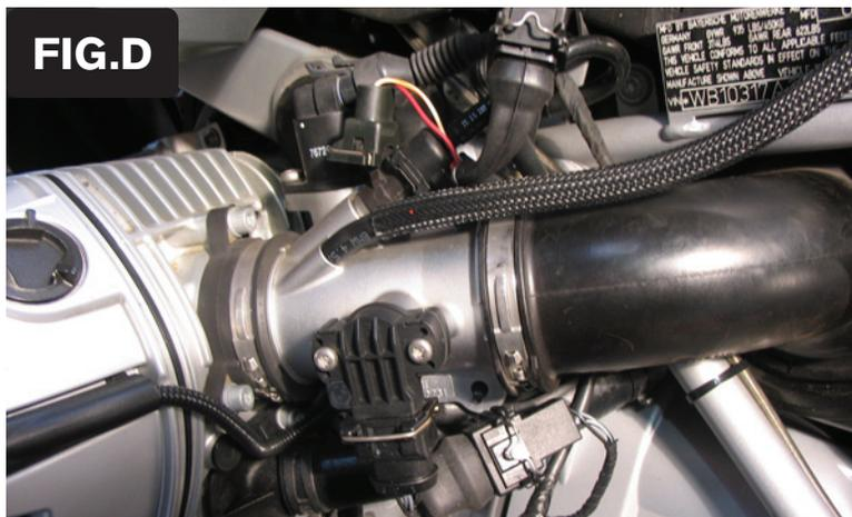
7. Guiar el mazo de cables del PCV por detrás del tubo de admisión.
