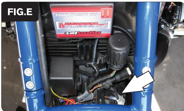
10. Colocar el PCV en la zona de debajo del sillín. Dependiendo de la colocación, utilizar las cintas de velcro o las bandas de sujeción para asegurar el módulo en su posición.
