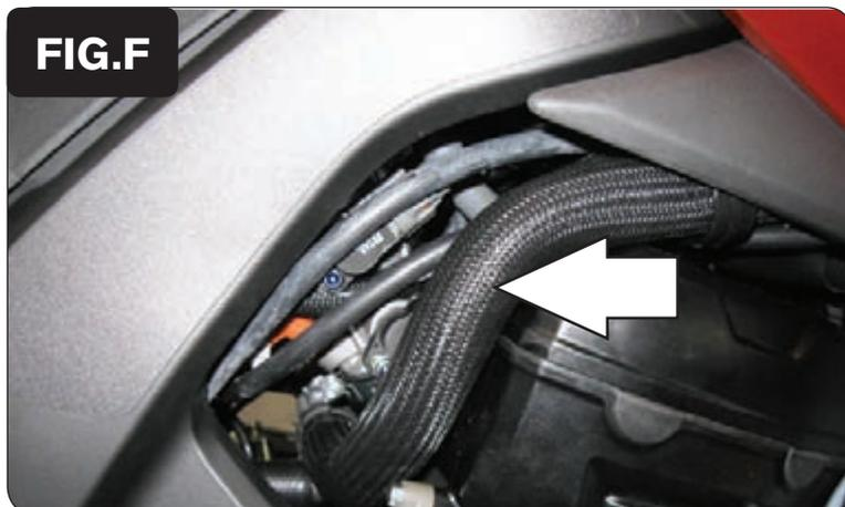
9. Localizzare il connettore del sensore di posizione farfalla sul lato destro della moto.
